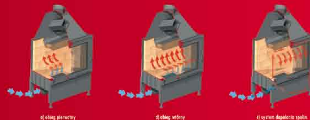
Schematy doprowadzenia oraz cykl obiegu powietrza wewnątrz komory spalania
